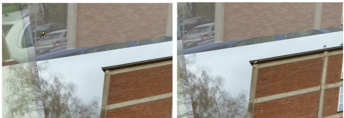
Obrázok 20. Obrázok vľavo znázorňuje situáciu pred premiestnením a obrázok vpravo zobrazuje situáciu po premiestnení pinu na správne miesto.
